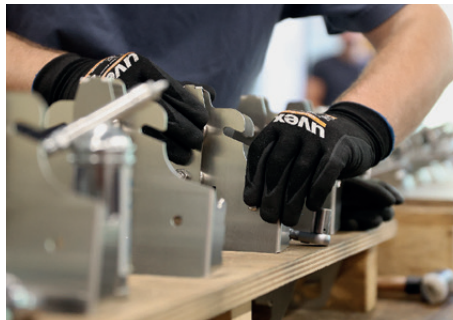
Zusammenbau der Tragrollen, Kugellager und Hülsen nach definierten Vorgaben in den ARGO Werkstätten
